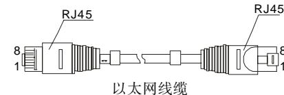
RJ45端口支持自动MDI/MDI-X操作，可以使用直通线连接PC或服务器，连接其它交换机或集线器。在直通线（MDI）中，管脚1、2、3、6对应连接；对于交换机或集线器的MDI-X端口，采用的是交叉线：1→3、2→6、3→1、6→2。MDI/MDI-X应用中10/100Base-T（X）引脚定义如下表所示。
