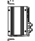
第二步：将交换机平贴在壁挂位置，移动交换机，使壁挂位置的螺孔与交换机挂耳贴合；
